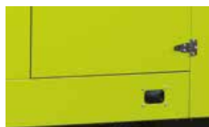
Отверстия для топливных трубопроводов
