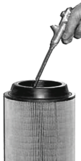
Рис. 6.3 Очистка фильтрующего элемента воздушного фильтра
